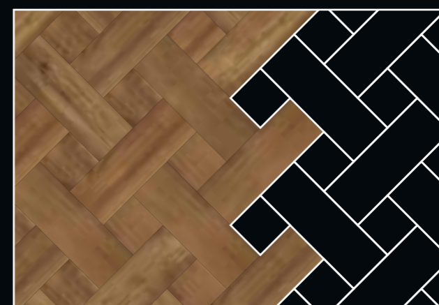
Korbgeflecht-Verlegung Basket weave
