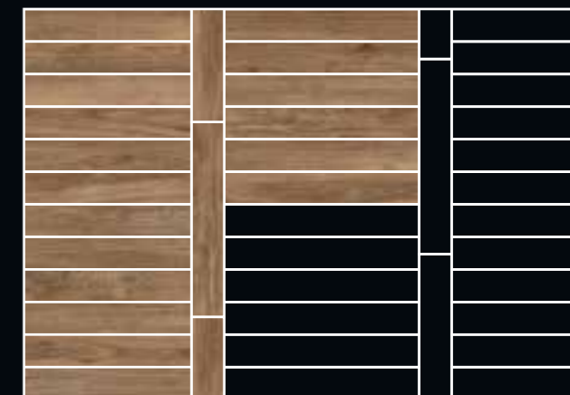
Leiterboden-Verlegung Ladder pattern
