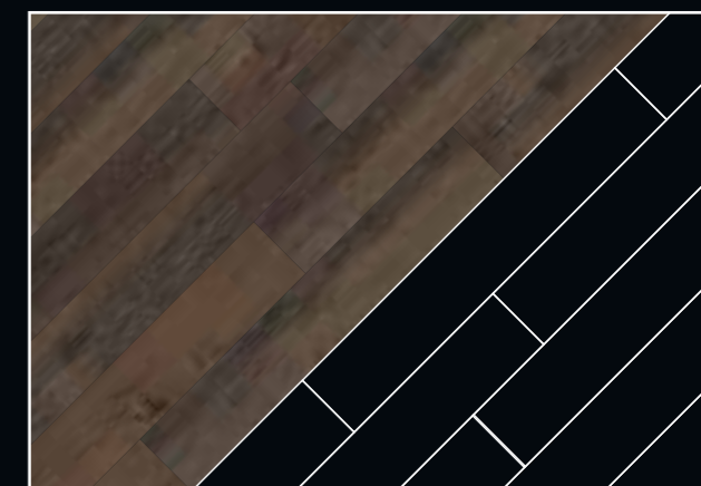
Diagonale Verlegung Diagonal lay
