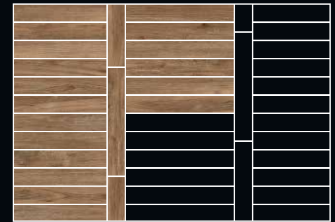
Leiterboden-Verlegung Ladder pattern
