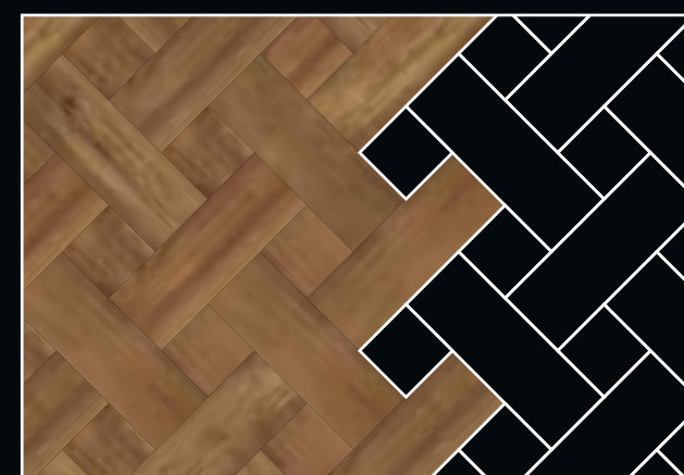
Korbgeflecht-Verlegung Basket weave
