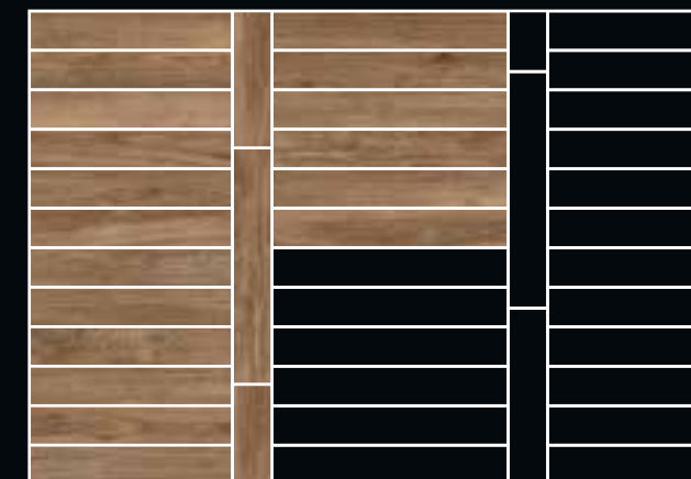
Leiterboden-Verlegung Ladder pattern
