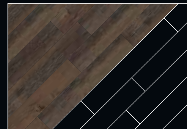
Diagonale Verlegung Diagonal lay
